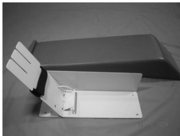
Figura 1 - Goniômetro utilizado
